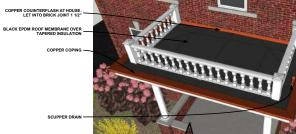
COPPER COUINTERFLASH AT HOUSE. LET INTO BRICK JOINT 1 1/2\*
