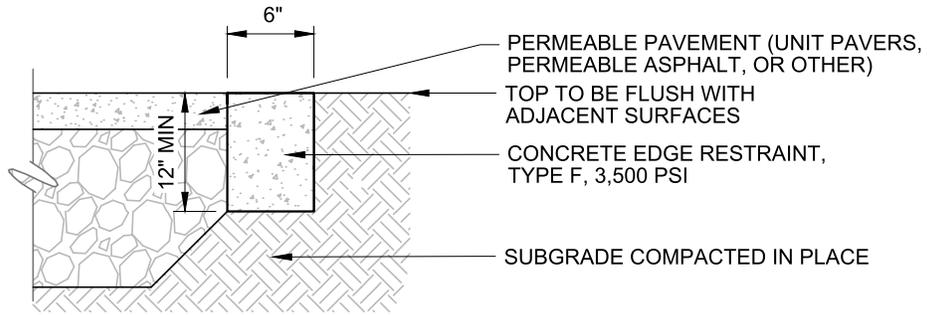
**FLUSH CONCRETE EDGE RESTRAINT**
